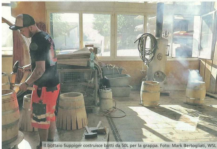
Il bottaio Suppiger costruisce botti da 50L per la grappa. Foto: Mark Bertogliati, WSL
